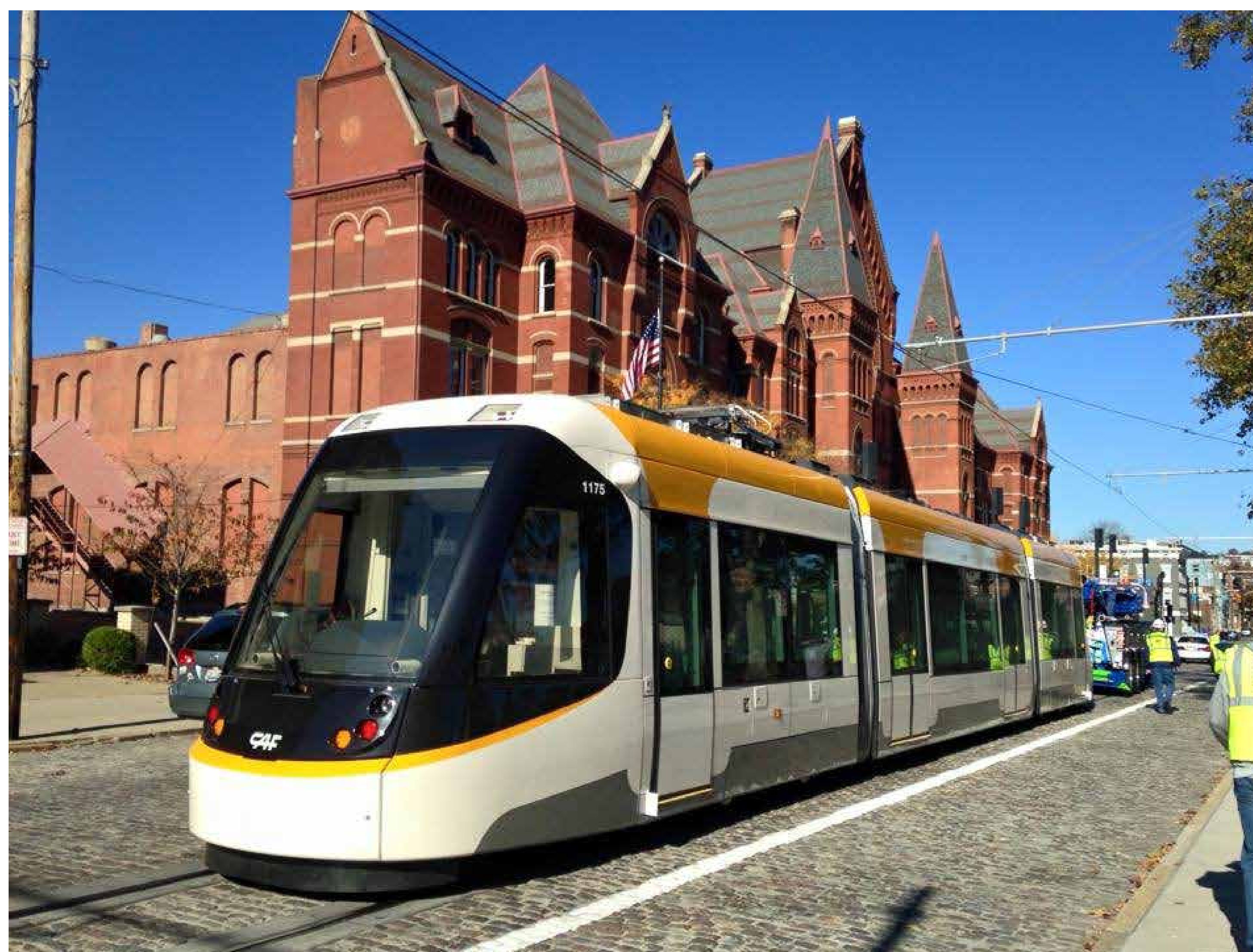
Tracks Level with Street Vías al nivel de la calle
